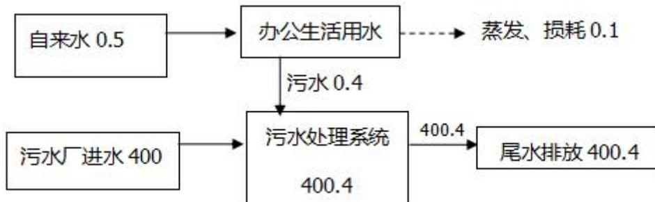
图 2-1 营运期水平衡图（满负荷状态下） 单位：m<sup>3</sup>/d
