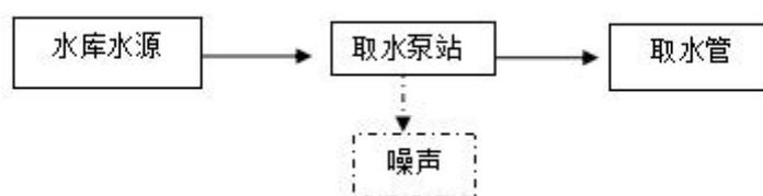
图 4-6 取水泵站工艺流程及产污图
