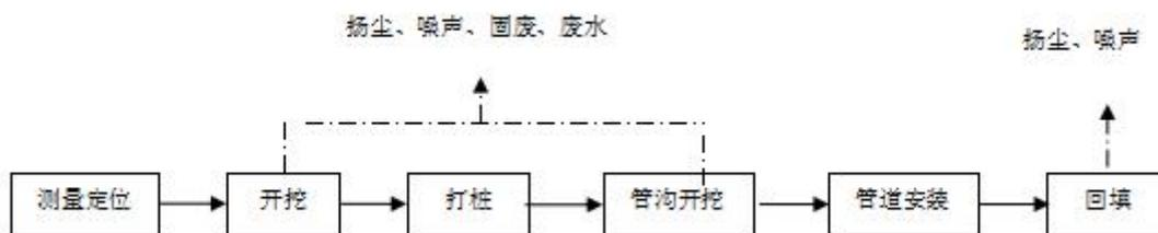
图 4-3 管道穿越公路施工工艺流程及产污图
